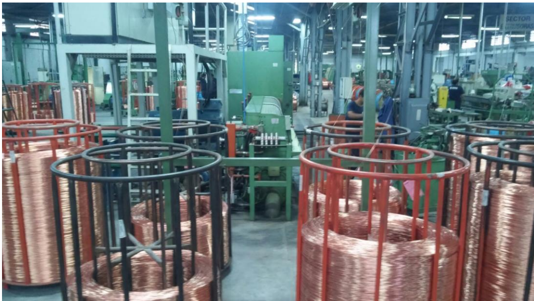
Figura 9 – Cestos de cobre com 1200 quilogramas
