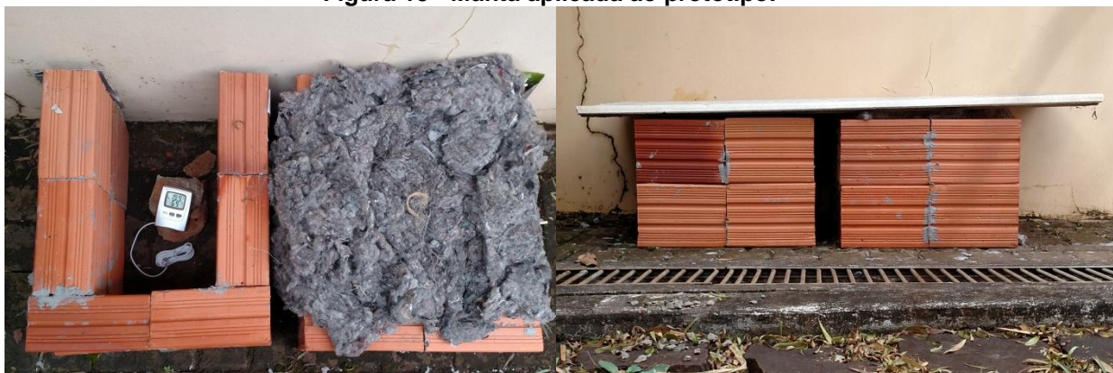
Figura 13 - Manta aplicada ao protótipo.
