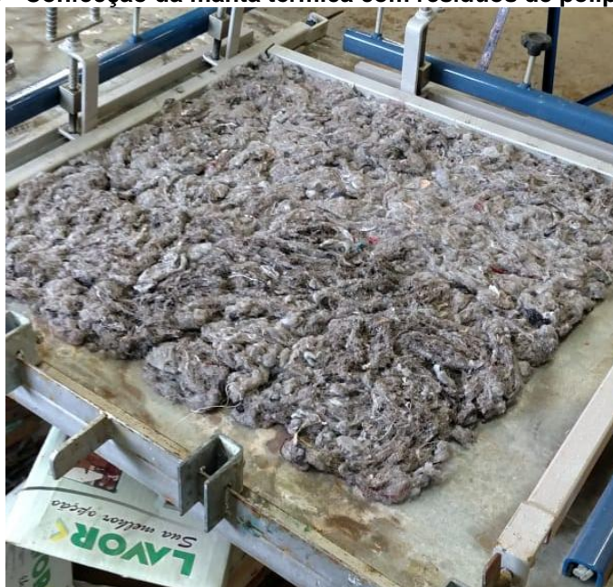
Figura 9 - Confeção da manta térmica com resíduos de polipropileno.
