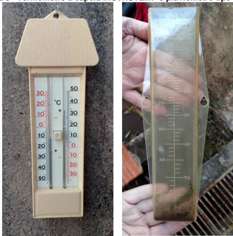
Figura 8 - Termômetro à capela INSTRUTEMP e pluviômetro tipo Cunha.
