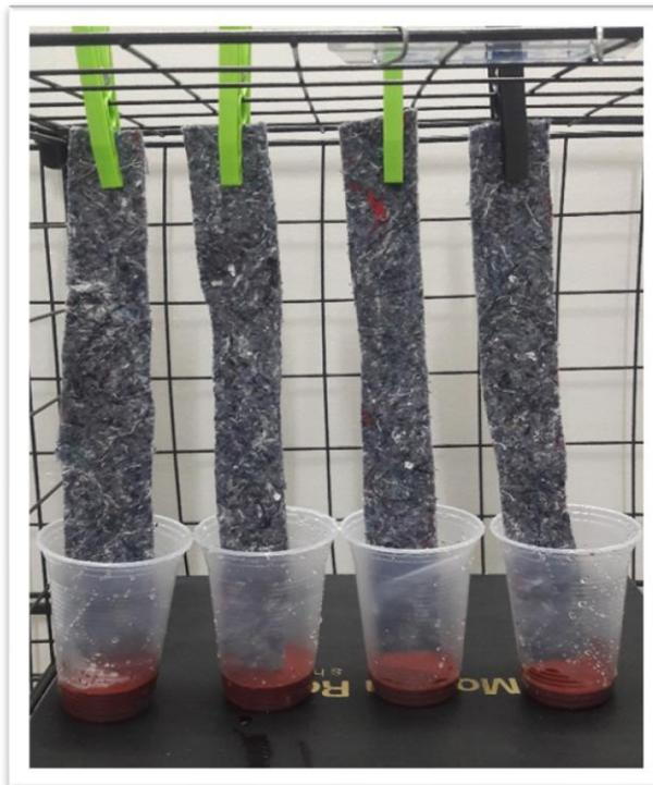
Figura 10: Estrutura do teste de Capilaridade – bojo CO/PES
