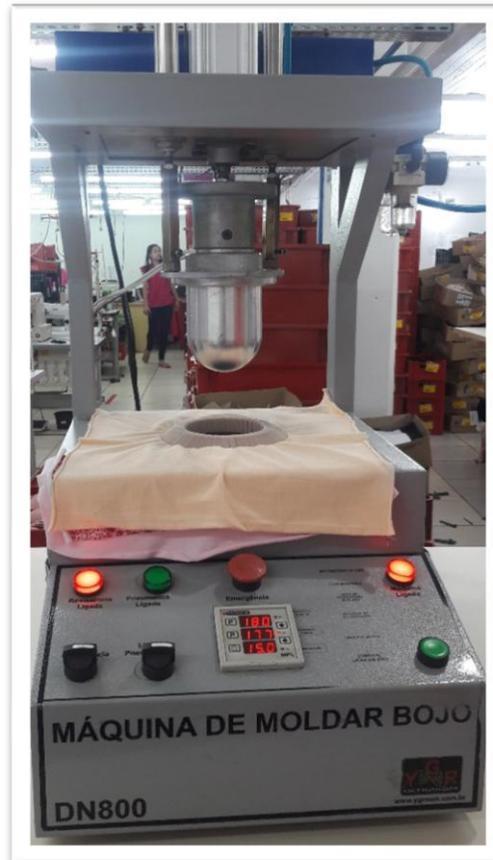
Figura 9: Máquina de moldar bojo
