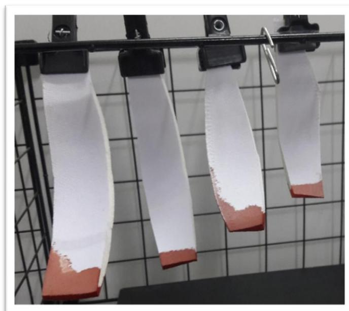
Figura 18: Resultado do teste de capilaridade - bojo espuma
