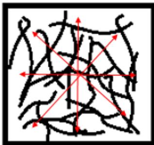
Figura 5: Orientação desordenada das fibras na manta de NT
