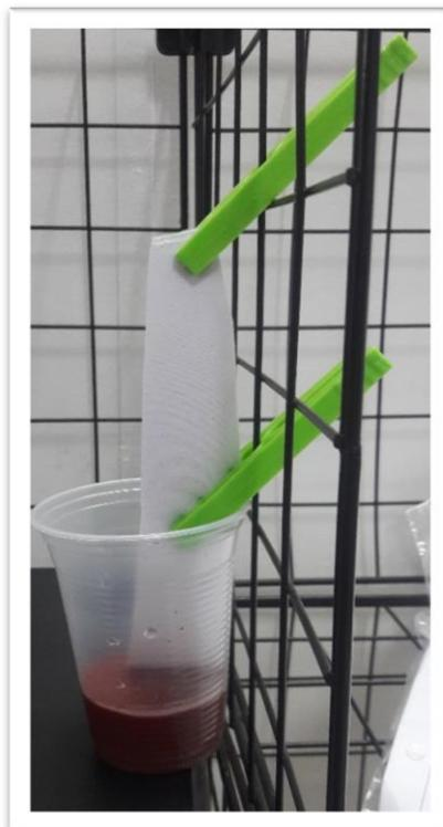
Figura 11: Estrutura do teste de Capilaridade - Bojo de espuma
