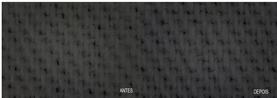
Figura 8 - Tecido cru antes e depois do processo de biodegradação
