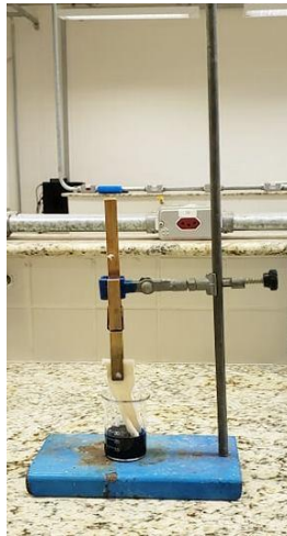
Figura 9 – Ensaio de capilaridade.
