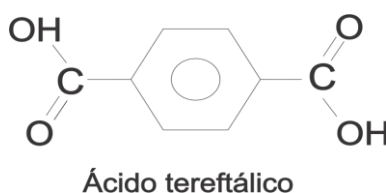
Figura 5- Estrutura química do ácido tereftálico.
