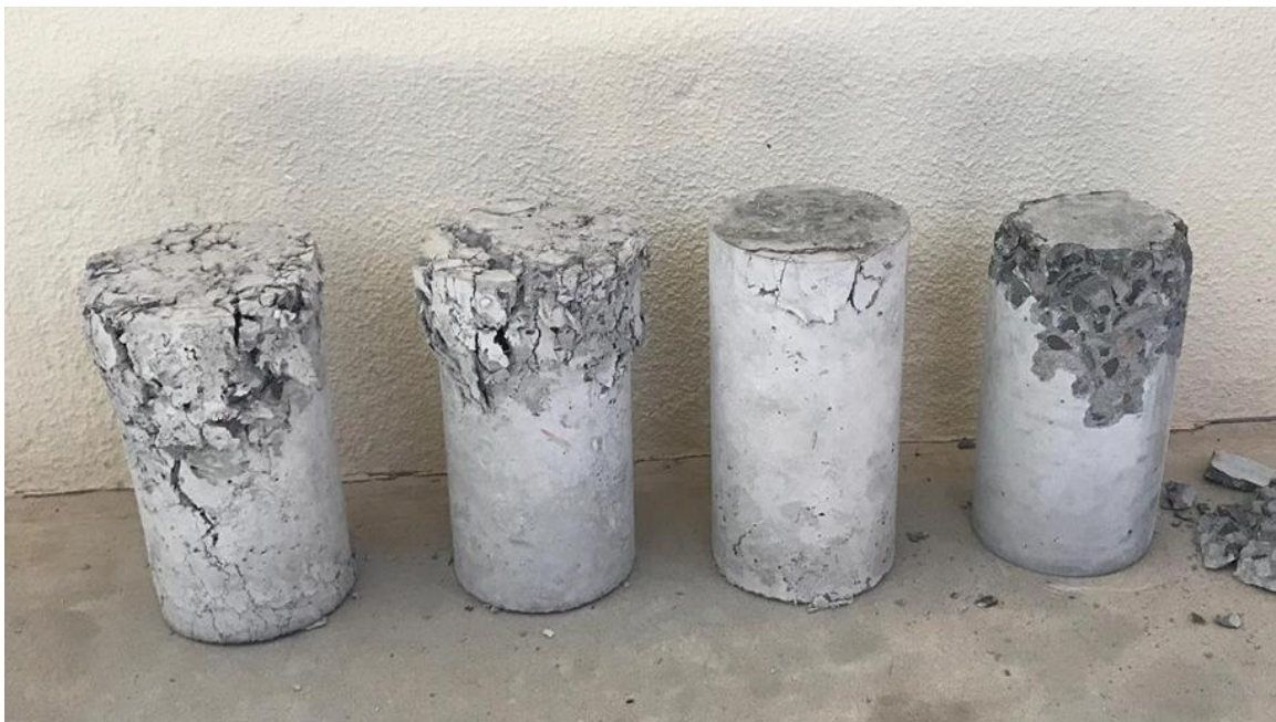
Figura 23 - Corpos de prova após ensaio de compressão
