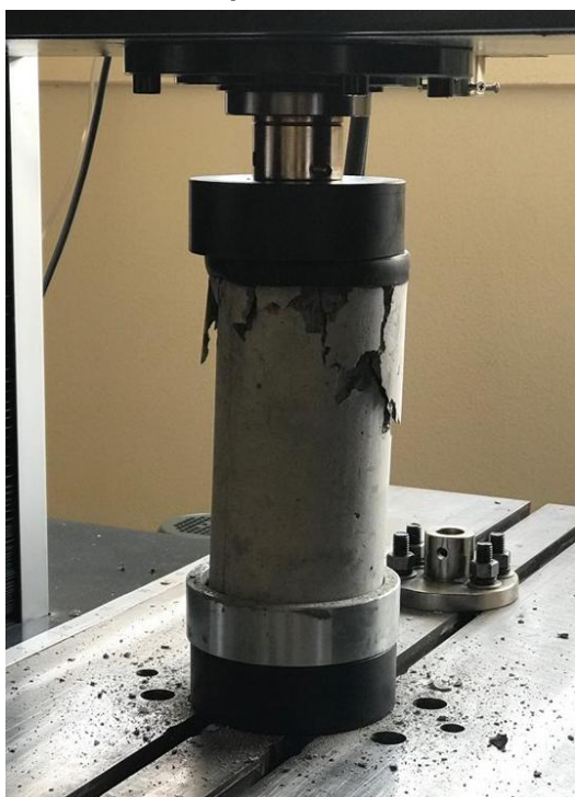
Figura 19 – Ensaio de Resistência à Compressão CP 0%
