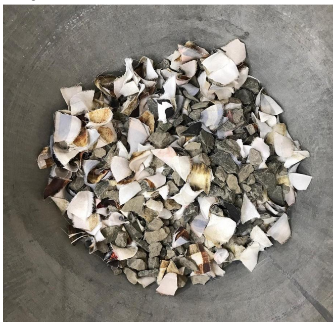
Figura 10 - Mistura de brita 1 com resíduos têxteis.
