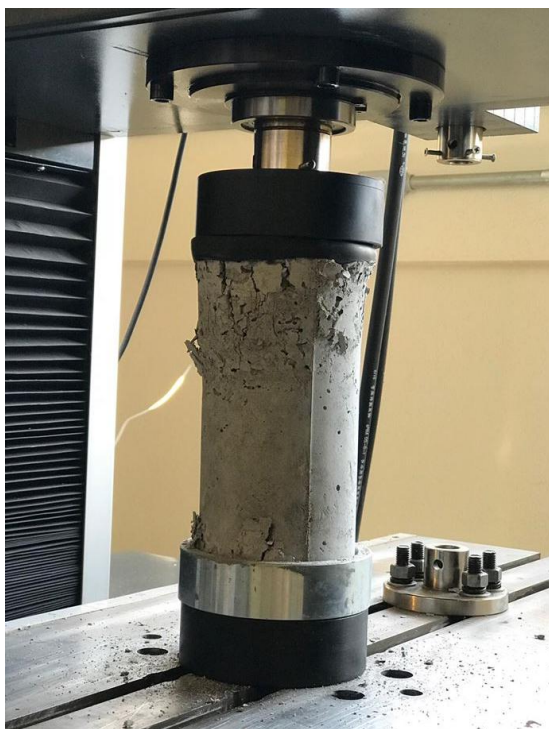
Figura 21 - Ensaio de Resistência à Compressão CP 2%
