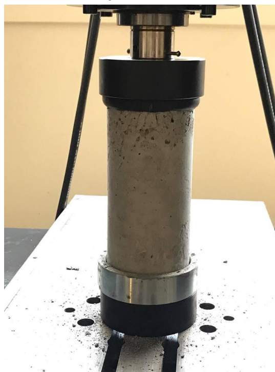
Figura 20 - Ensaio de Resistência à Compressão CP 1%
