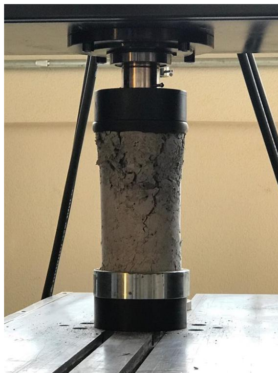
Figura 22 - Ensaio de Resistência à Compressão CP 3%
