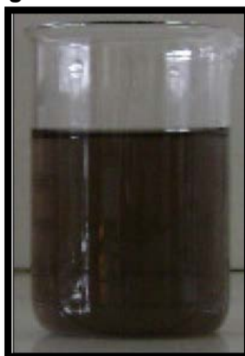
Figura 6 - Efluente da ETE
