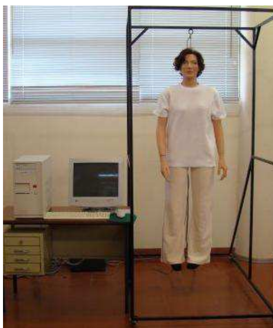
Figura 2: Manequim térmico usado para determinar o isolamento Fonte: Teixeira et al., 2011, p. 3.
