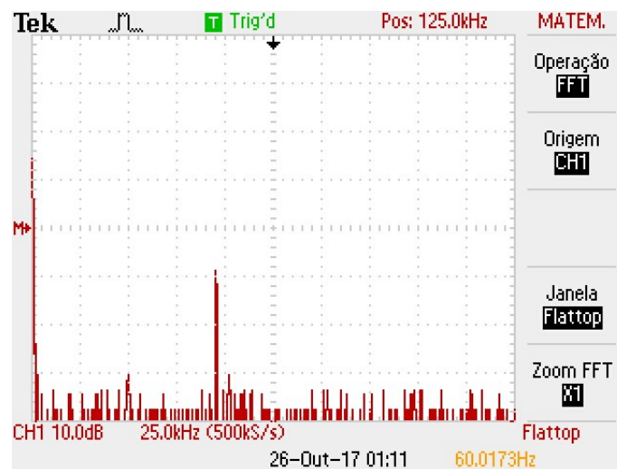
Figura 31 - FFT da rede com sinal de 96 kHz Fonte: Autoria Própria
