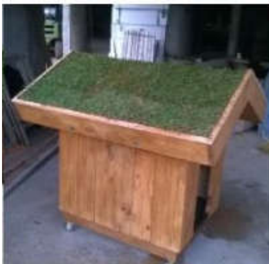
Figura 11 – Protótipo de telhado verde. Fonte: Hinning, Oriques e Hollas (2015).
