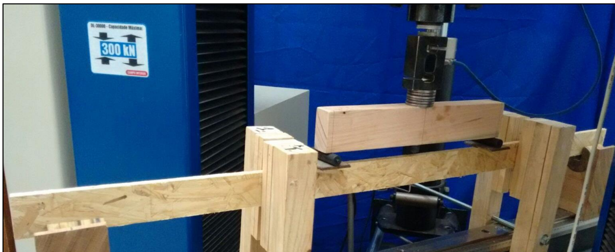
Figura 45 – Representação do ensaio de flexão Vertical
