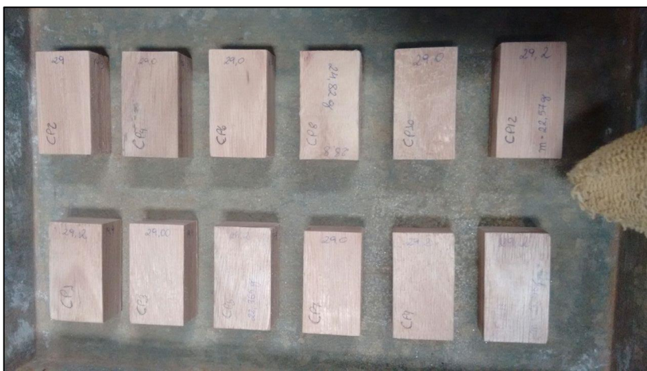
Figura 34 – Corpos de prova para determinação da umidade e densidade aparente
