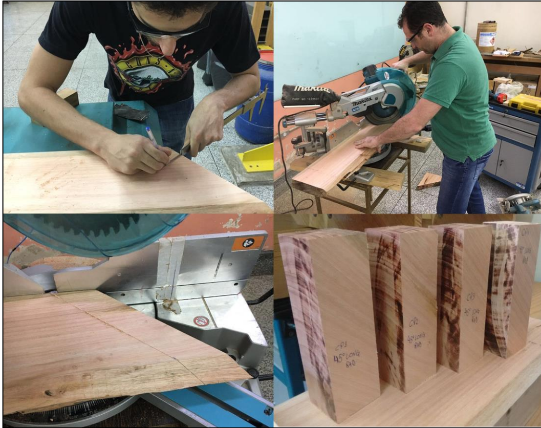
Figura 30 – Confeção dos corpos de prova com inclinação de 45° no plano Longitudinal-Radial.
