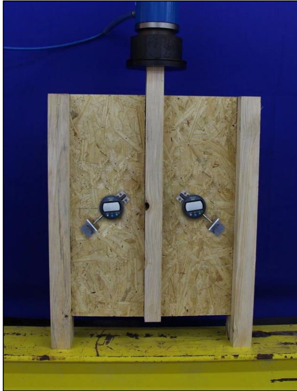
Figura 47 - Ensaio de cisalhamento ao longo da espessura adaptado da norma ASTM D2719 (2002)
