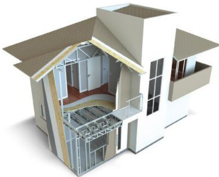
Figura 2 - Esquema Construtivo em Light Steel Frame Fonte: Smart Sistemas Construtivos (2017).
