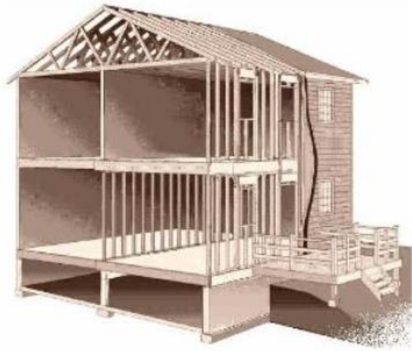
Figura 3 - Esquema Construtivo em Wood Frame Fonte: Silva (2004).
