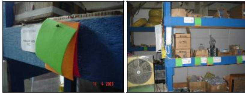
Figura 2 – Detalhe dos kanbans de sinalização instalados no almoxarifado Fonte: Barros Neto et al (2005)
