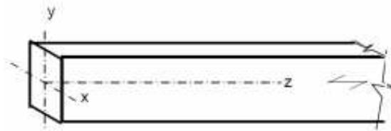
**Figura 9: Convenção de eixos ortogonais para elementos fletidos**
