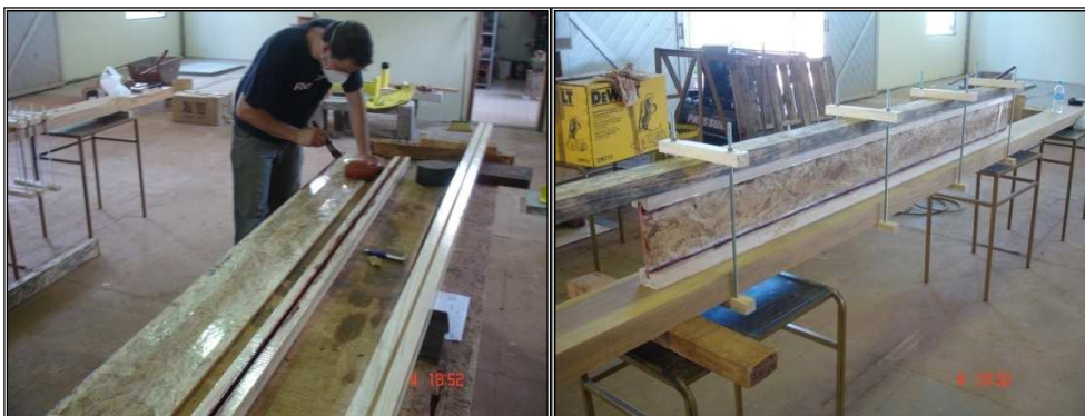
Figura 18- Montagem da viga “I” Fonte: Autor.
