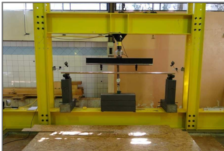
Figura 16- Arranjo bi-apoiado para ensaio de módulo de elasticidade das mesas. Fonte: Autor.
