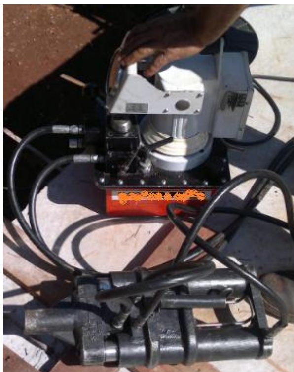
Figura 12 – Conjunto moto bomba
