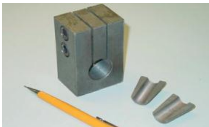
Figura 11 – Dispositivo de ancoragem provisória e cunhas tronco-cônicas Fonte: Cauduro (2002, p. 14).
