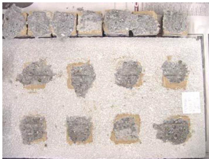
Figura 13 - Ensaios de arrancamento
