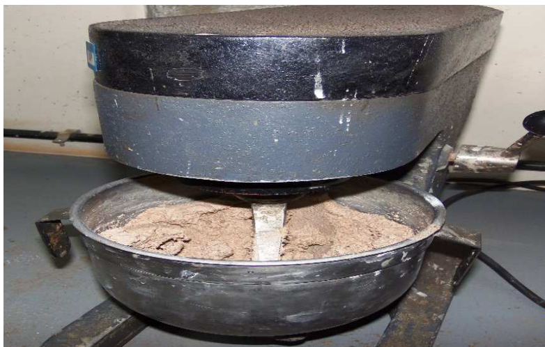
Fotografia 2 – Mistura de cal, areia e água no misturador
