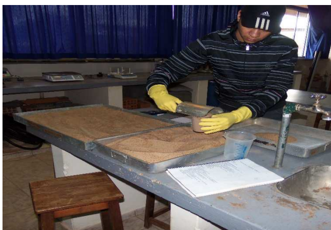
Fotografia 1 – Areia seca para o preparo da argamassa
