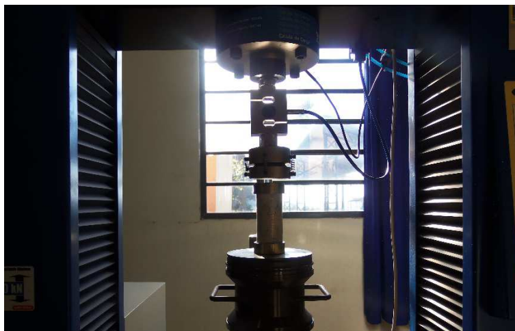
Fotografia 6 – Ensaio de resistência à compressão
