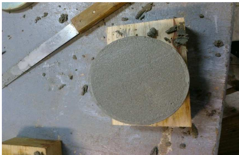
Fotografia 4 – Molde pronto para receber gases, papel filtro e o peso de 2 kg
