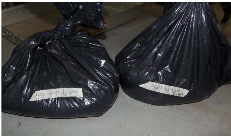
Fotografia 3 – Armazenagem da mistura de cal, areia e água
