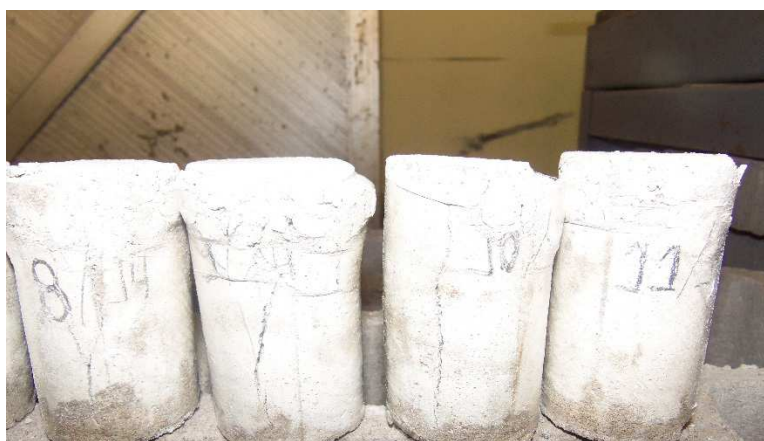
Fotografia 7 – Detalhe da ruptura dos corpos de prova
