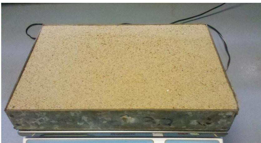
**Fotografia 3 - Recipiente completo para determinação da massa específica aparente**
