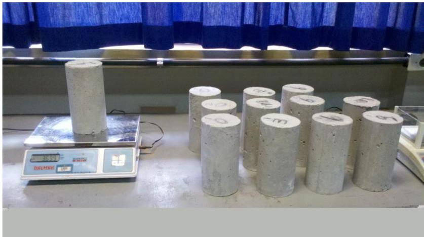
**Fotografia 9 – Ensaio para determinação da absorção de água no concreto**
