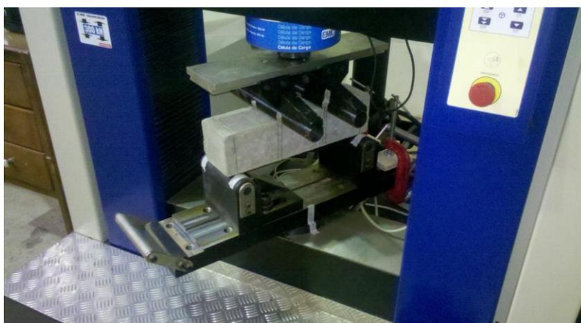
**Fotografia 8 – Ensaio de resistência à tração na flexão em corpos de prova prismáticos**
