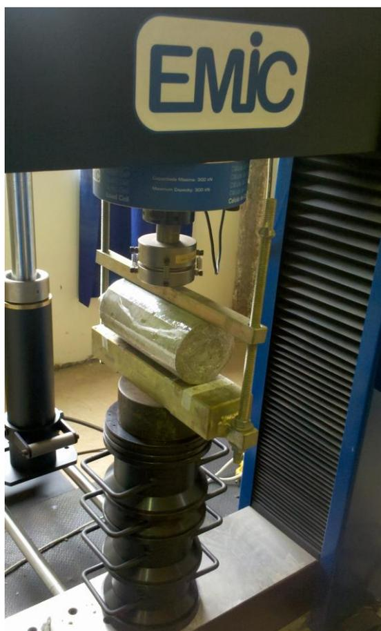
**Fotografia 7 – Ensaio de tração por compressão diametral**
