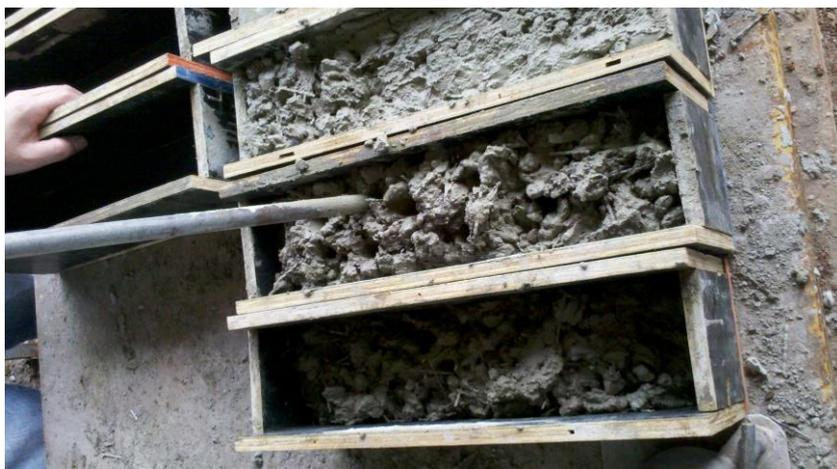
**Fotografia 5 - Moldagem dos corpos de prova**
