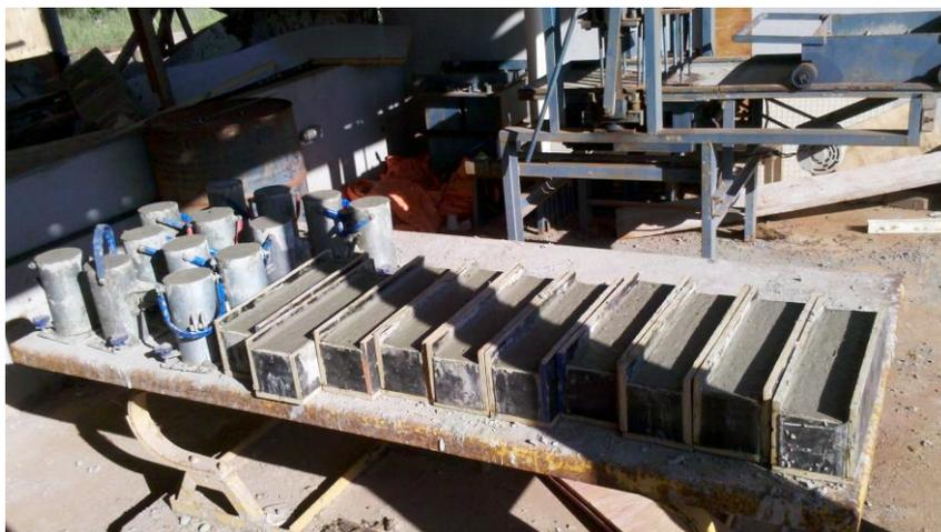
**Fotografia 6 – Corpos de prova armazenados em local protegido por 24 horas**
