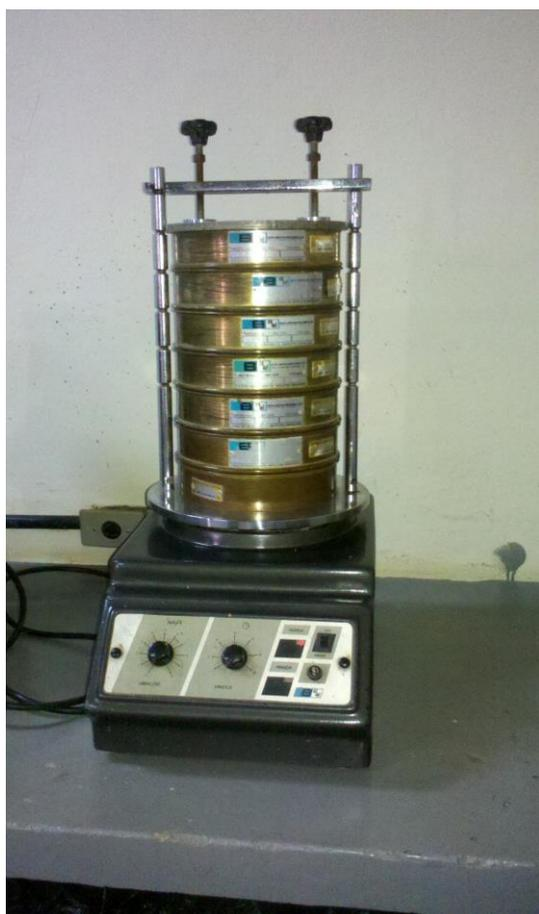
Fotografia 2 – Conjunto de peneiras e peneirador para ensaio de granulometria
