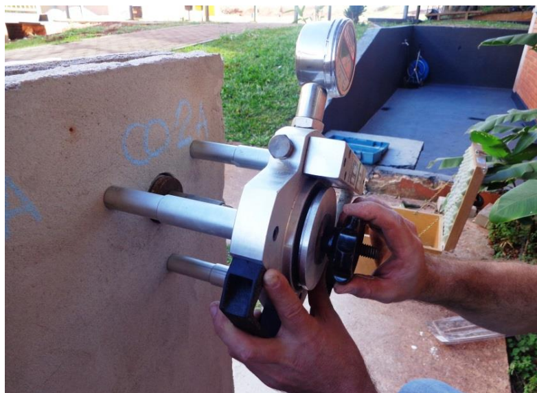
Figura 38 - Ensaio de aderência à tração.
