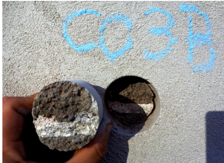
Figura 40 - Rompimento do substrato
