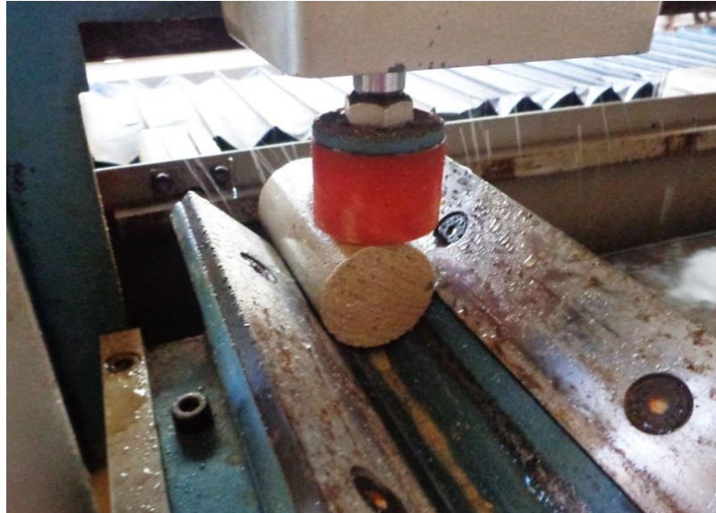
Figura 30 - Retificação do corpo de prova de argamassa
