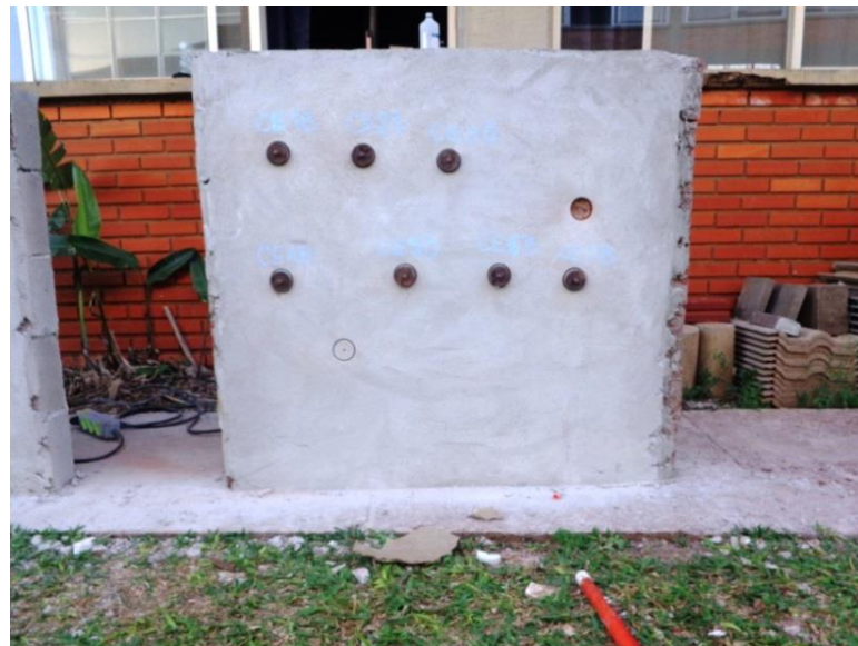
Figura 35 - Mapeamento das amostras no protótipo de bloco cerâmico (Lado B)
