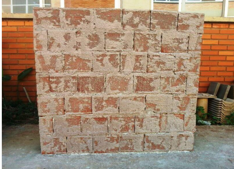
Figura 16 - Chapisco rolado sobre substrato cerâmico (Lado B)
