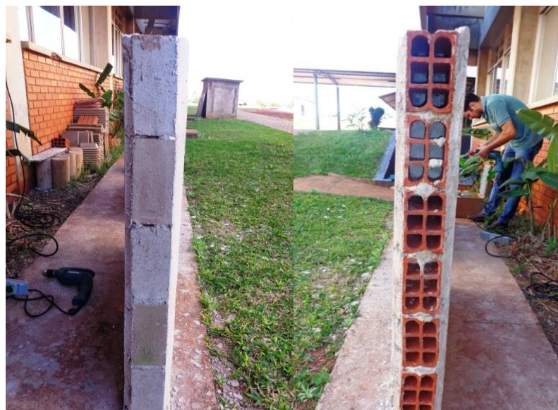
Figura 21 - Espessura dos revestimentos dos protótipos
