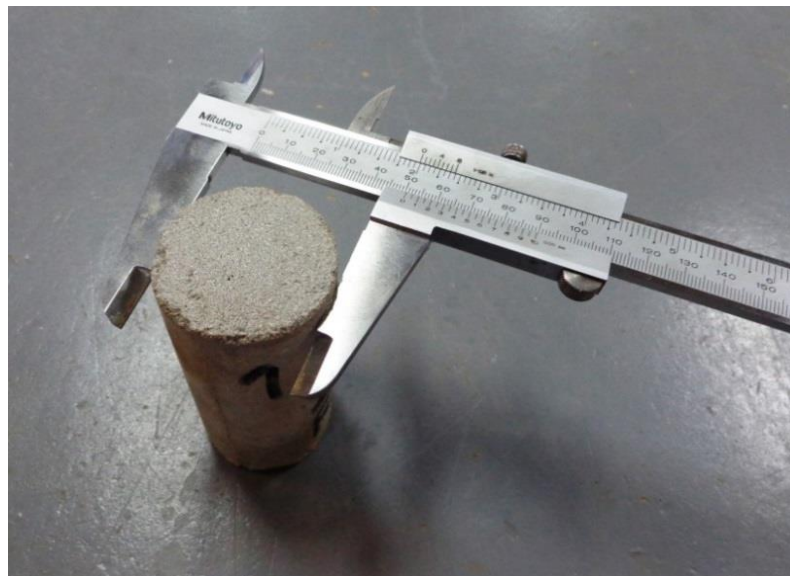
Figura 31 - Determinação do diâmetro dos corpos de prova
