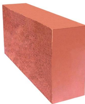
Figura 29: Tijolo maciço (5x10x21) cm na configuração ½ vez.
