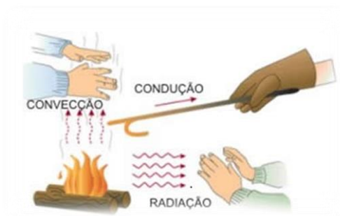
Figura 3: Processos de transferência de calor: condução, convecção e radiação.
