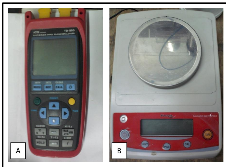
Figura 12. (A) Foto do termômetro digital (TD- 890) utilizado para medição das temperaturas ( T_1 e T_2 ); (B) Foto da balança eletrônica utilizada para medição das massas de água e gás ( m_a e m_g ).
