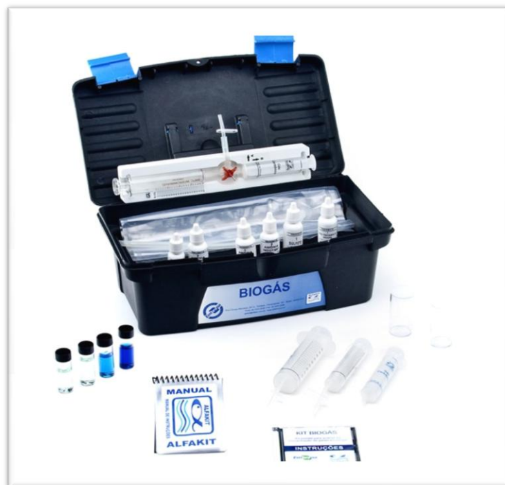
Figura 10. Foto do kit comercial para análise de biogás (Alphakit)
