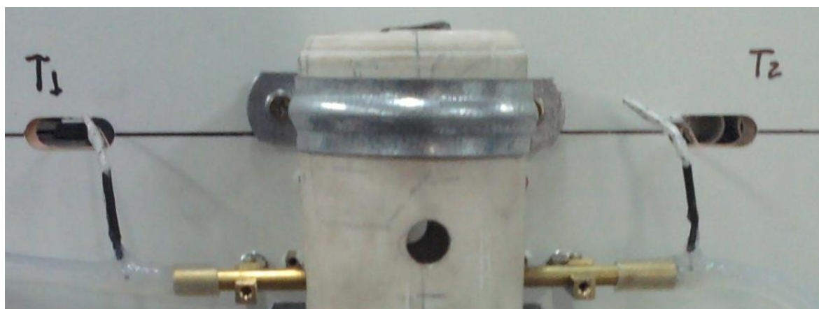
Figura 11. Pontos de medição da temperatura ( T_1 e T_2 ) antes da chama, e logo após a passagem pela mesma.
