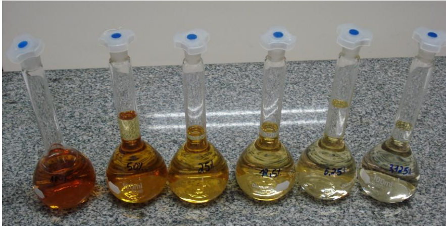
Figura 6 – Fotografia das diluições do efluente Água Vermelha da indústria de explosivos para o teste com D. magna .
