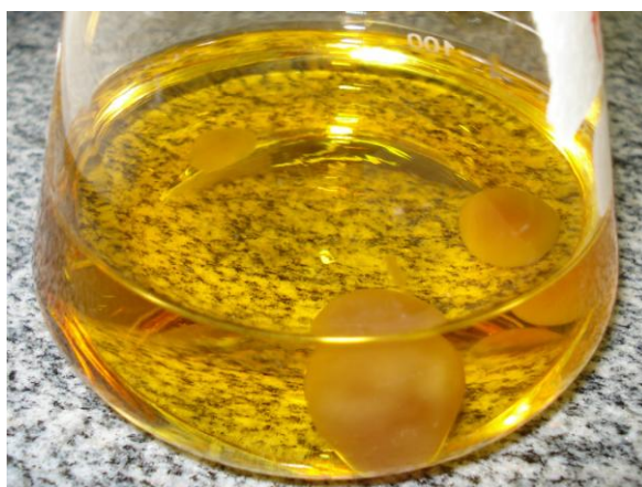
Figura 21 – Fotografia mostrando a formação de pellets durante o tratamento fúngico nos Erlenmeyers.
