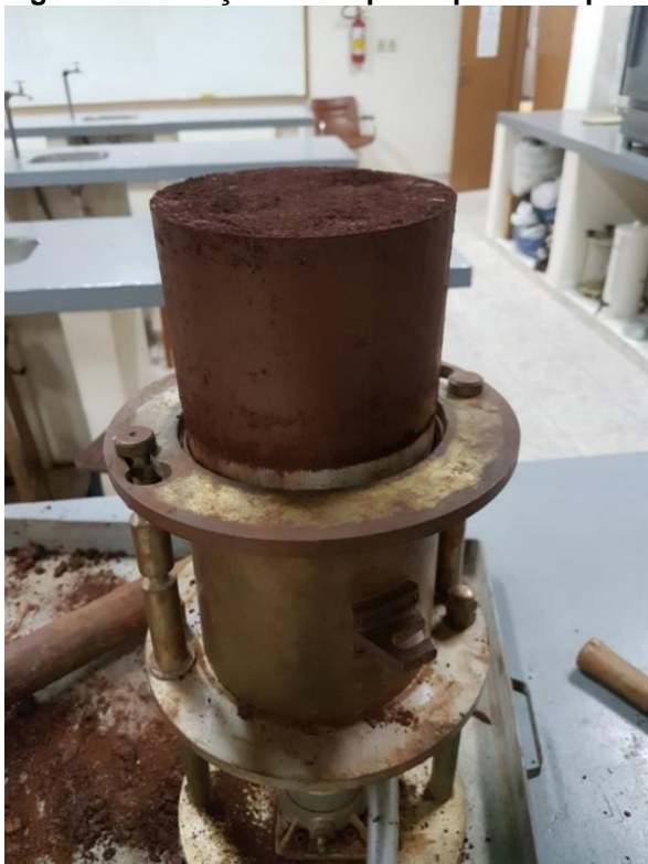
Figura 2 - Extração do corpo de prova do proctor.
