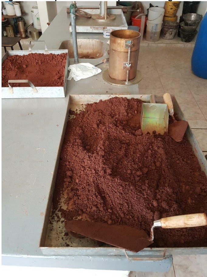
Figura 4 – Preparo da mistura para a moldagem do corpo de prova.
