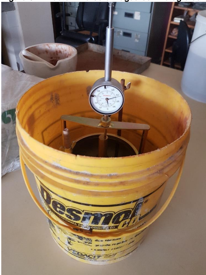
Figura 5 – Proctor imerso em água com relógio comparador.
