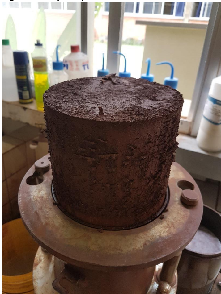
Figura 8 – Corpo de prova da mistura de 50% de RCD e 50% de Solo.
