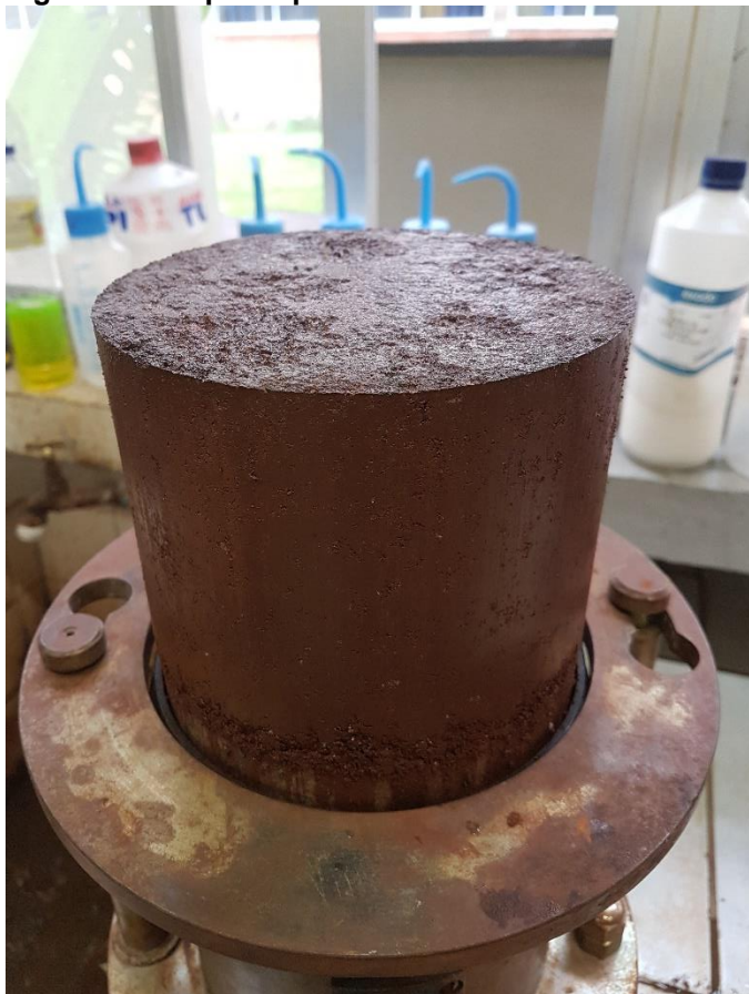
Figura 7 – Corpo de prova da mistura de 25% de RCD e 75% de Solo.
