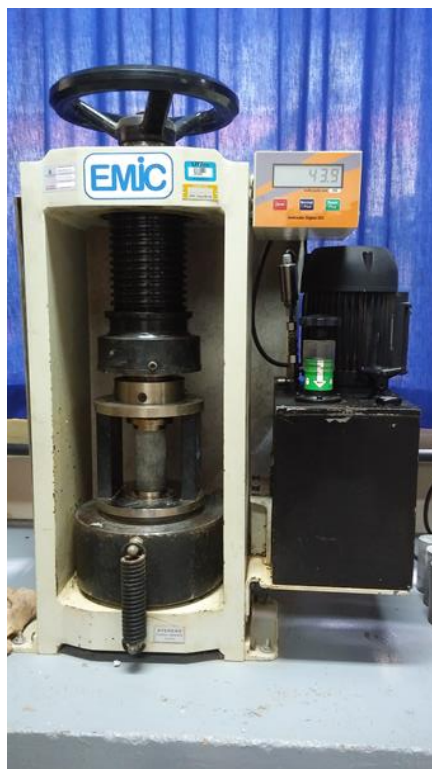
Figura 9 – Ruptura de corpos de prova a compressão
