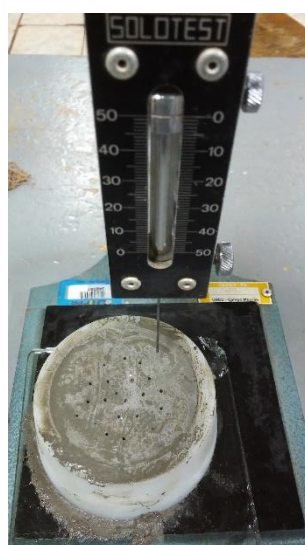
Figura 4 – Ensaio de fim do tempo de pega
