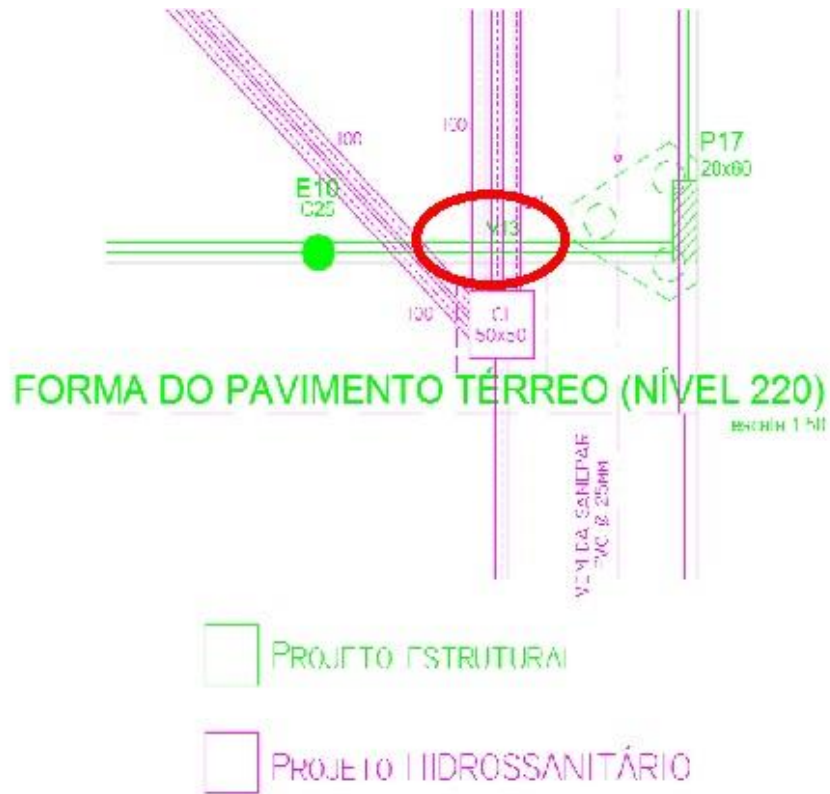
Figura 15 – Possível interferência entre tubulação de esgoto e viga baldrame Fonte: projetos fornecidos pela construtora
