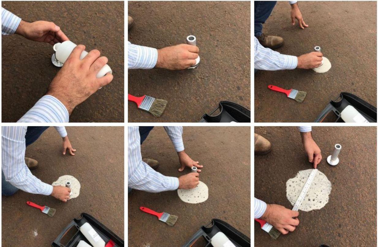
**Figura 13 – Processo do ensaio de Mancha de Areia**
