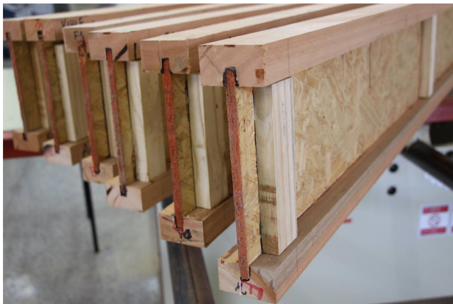
Figura 3 - Vigas I-Joist Fonte: Tatiana Carlin (2015)
