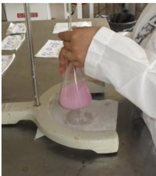
Figura 4. Cor indicativa na titulação realizada para determinar a quantidade de carboxila e carbonila.
