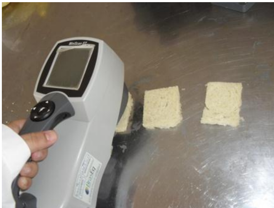
Figura 3. Utilização do aparelho colorímetro para realização do teste de colorimetria nas amostras de cada formulação de pão analisada.
