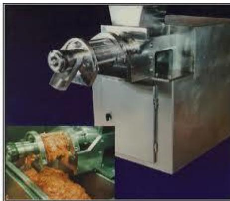
Figura 2: Máquina de Separação Mecânica de Carnes (Fonte: Degenhardt, 2006)
