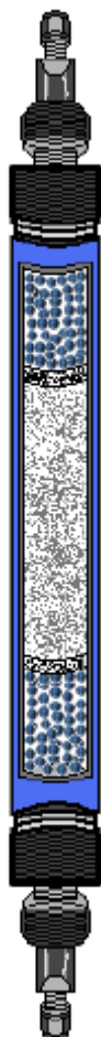
Figura 4: Vista interna do reator, sendo, parte superior e inferior com perolas de vidro, e no centro o catalisador Amberlyst® 15 compreendido entre peneiras possibilitando leito fixo.
