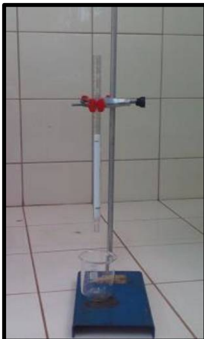
Figura 6. Coluna de adsorção para percolação da solução de simulação do efluente.
