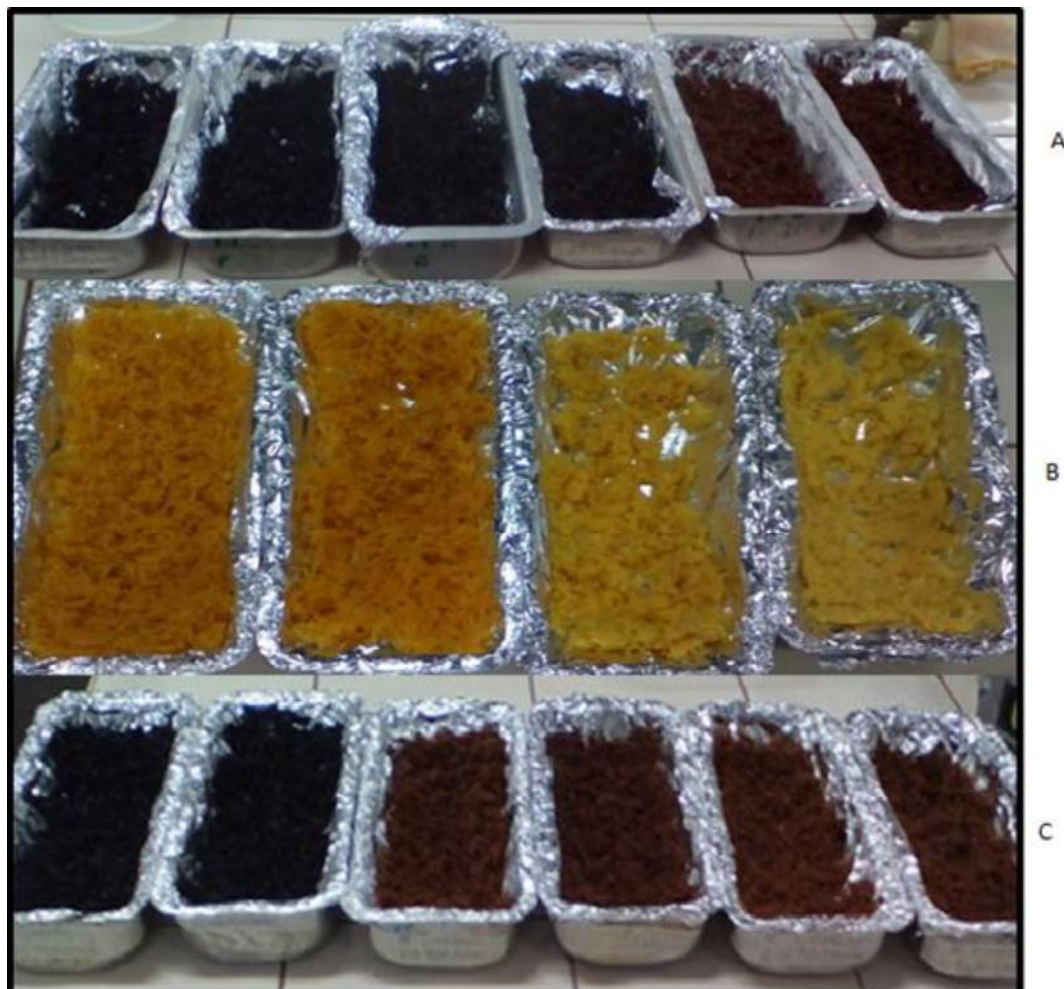
Figura 4. Amostras após tratamento ácido sob refluxo de 3 horas. A: Tratamento com ácido sulfúrico, B: com ácido nítrico e C: com ácido clorídrico.
