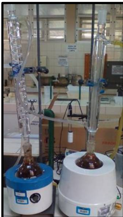
Figura 3: Aquecimento das amostras em manta mantidas sob refluxo.
