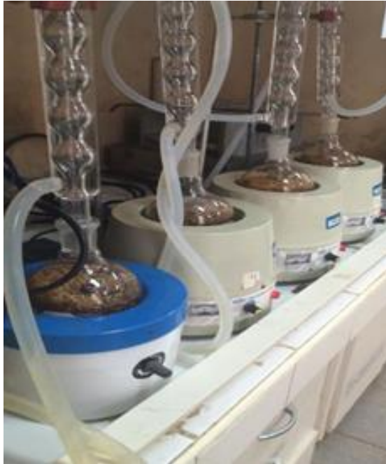
Figura 3. Aquecimento das amostras em manta mantidas sob refluxo
