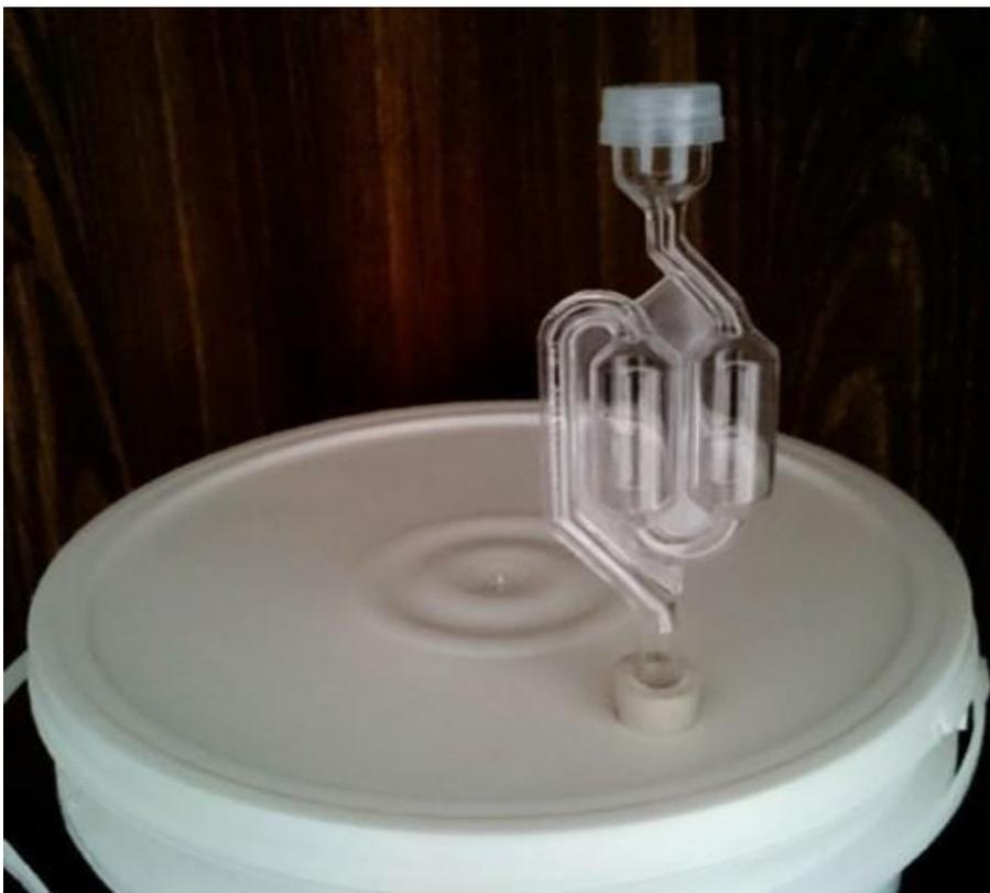
Figura 2 – *Air-lock* no fermentador.
