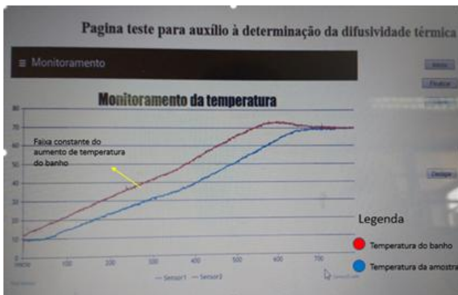
Figura 3 –Interface gráfica computacional de aquisição dos dados para o cálculo da difusividade térmica.
