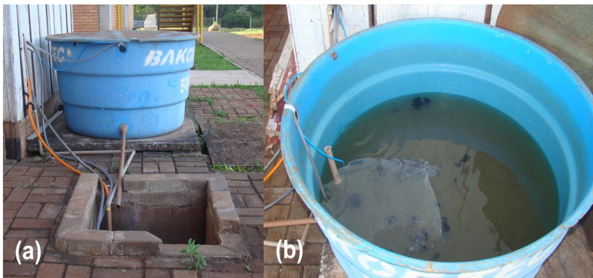
Figura 6 - Tanque de equalização utilizado para o experimento. (a) vista frontal. (b) aflente no interior do tanque.
