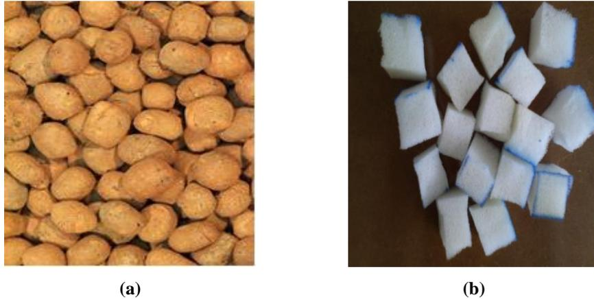
**Figura 3 – Materiais suporte para imobilização da biomassa: a) argila expandida, b) espuma de poliuretano.**
