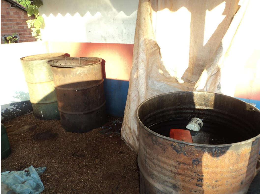
Figura 4 – Armazenamento inadequado de óleo lubrificante usado.
