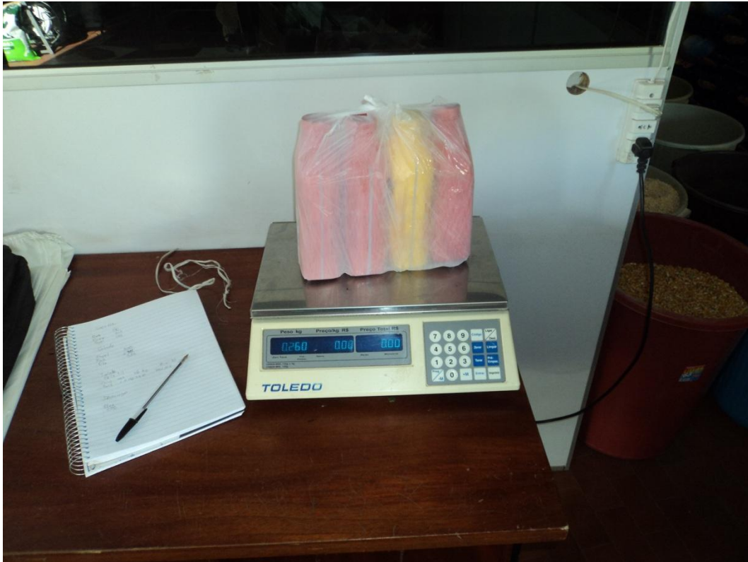
Figura 1 - Balança eletrônica TOLEDO PRIX III
