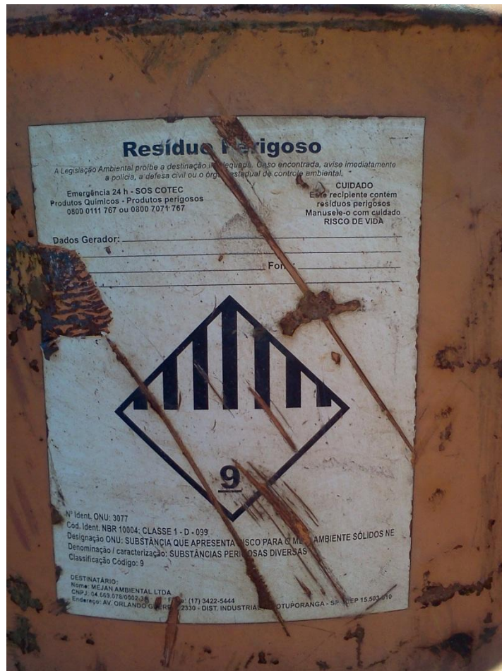
Figura 9 - Tambor de resíduo perigoso devidamente sinalizado
