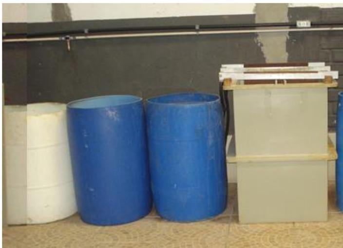
**Figura 9 – Tanque de desengraxe eletrolítico, duas bombona plásticas azuis para enxágue e uma branca para ativação ácida.**
