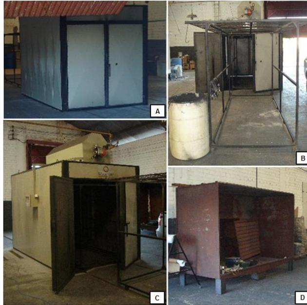
Figura 12 - Estufa para cura da peças. A) Estufa fechada para cura das peças B) Estufa, barril com tinta, e carrinho, onde as peças são penduradas; C) Estufa aberta; D) Futura cabine para aplicação de tinta.
