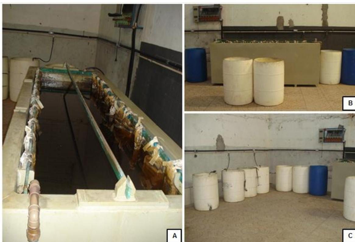
**Figura 10 – Etapas finais do processo de zincagem. A) e B) Tanque de zincagem; C) Bombona plástica azul para enxágue, seguida de bombonas para clareador, passivação e enxágue.**
