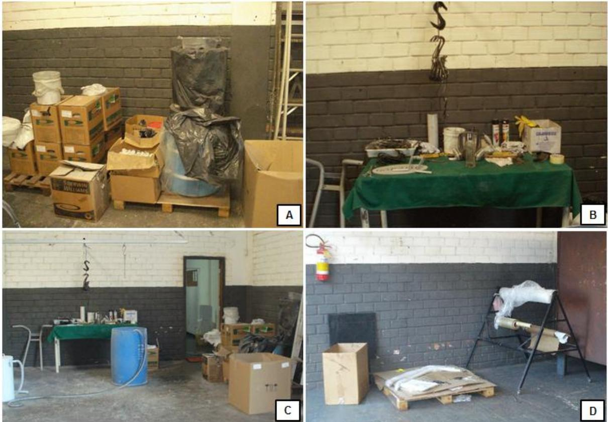
**Figura 13 – Demais materiais para pintura eletrostática. A) Armazenagem das caixas de tinta; B) Mesa com materiais para a pintura eletrostática; C) Ambiente com materiais para pintura; D) Materiais para embalagem das peças.**
