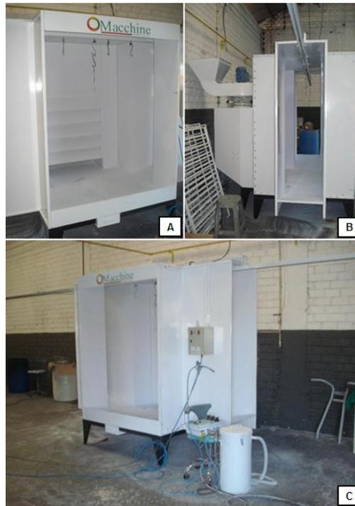
Figura 11 – Detalhes da cabine para aplicação da tinta em pó. A) Vista frontal; B) Vista lateral, detalhe do exaustor de tinta; C) Cabine para aplicação da tinta em pó e equipamento da pistola para aplicação da tinta.
