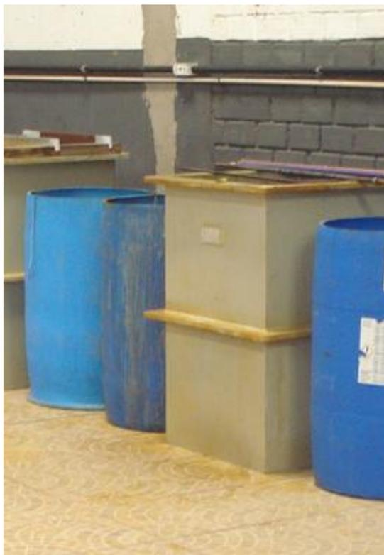
**Figura 8 – Tanque de decapagem ácida e duas bombonas plásticas azuis para enxágue.**
