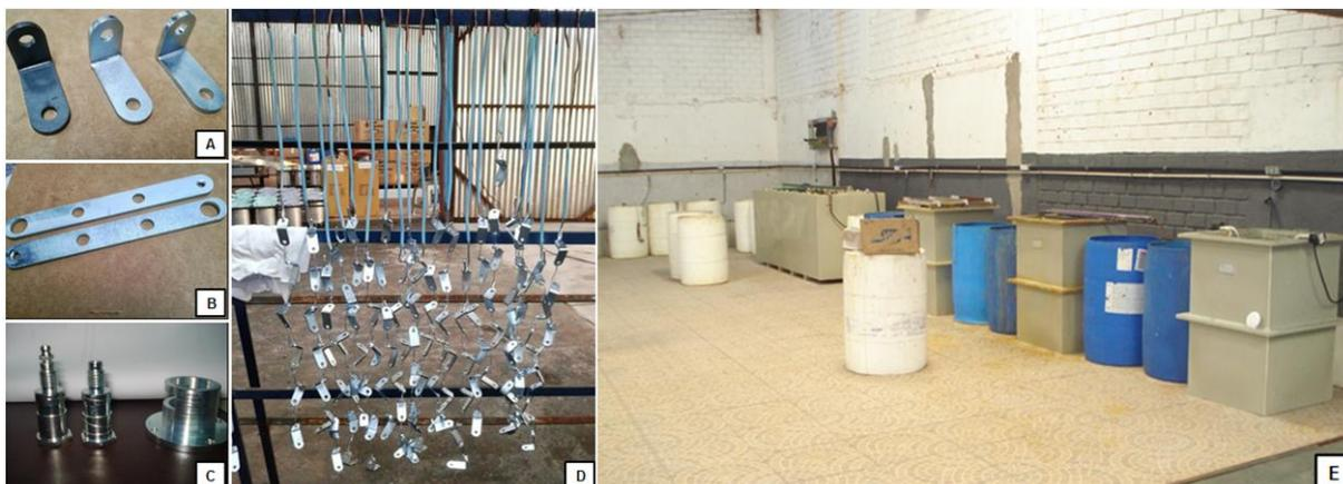
**Figura 6 – Peças de ferro do tratamento de zincagem e linha de tratamento. A) e B) Comparação entre peças com a superfície tratada e não tratada; C) Exemplo de peças tratadas pela zincagem; D) Peças zincadas engancheiradas e E) Linha de banhos químicos da zincagem.**
