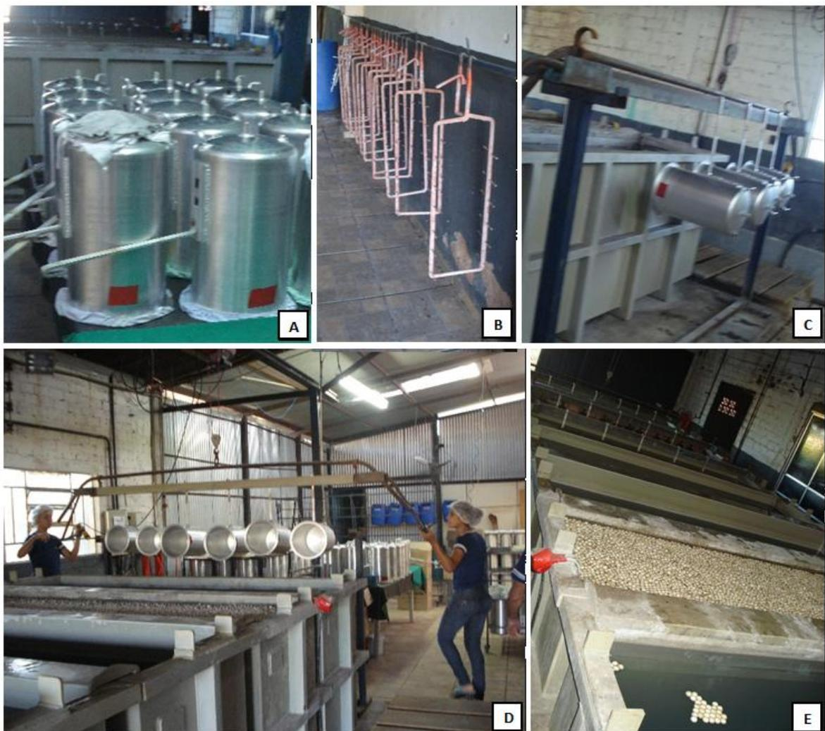
**Figura 3 – Preparação e parte dos processos de anodização. A) Cubas adesivadas e com ganchos; B) Ganchos tipo 2; C) Cubas engancheiradas; D) Estrutura com auxílio de**
