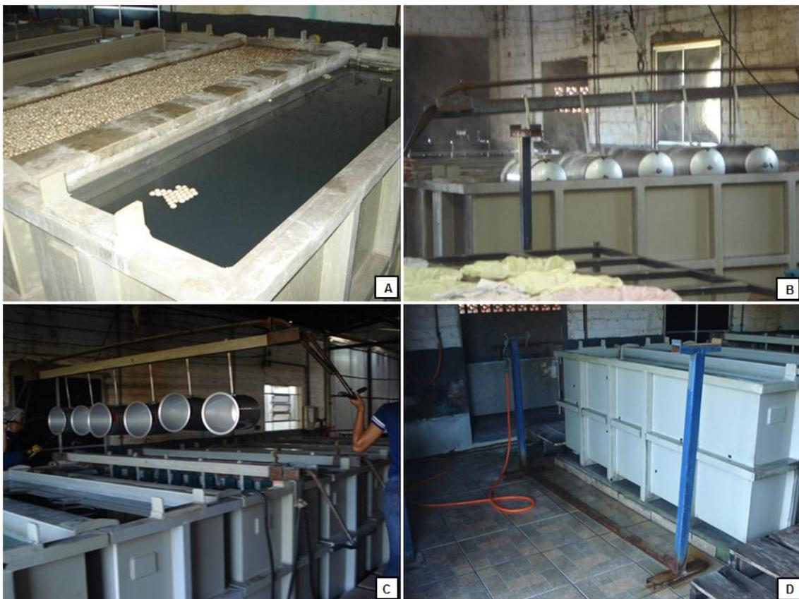
Figura 4 – Etapas do processo de anodização. A) Tina com água para enxágue e tina para fosqueamento; B) Cubas sendo imersas na tina com soda caustica para fosqueamento;
