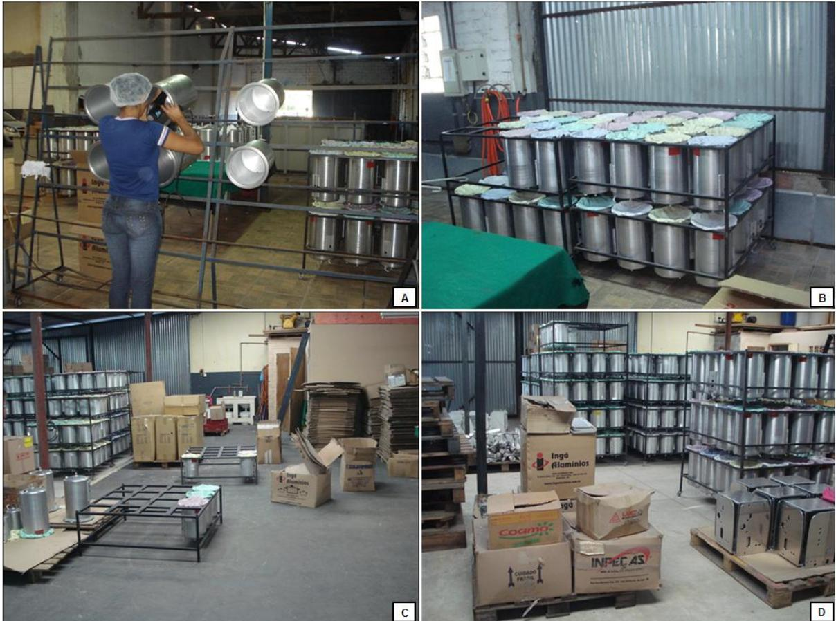
**Figura 5 – Etapas finais do processo de anodização. A) Secagem das cubas; B) Cubas com touca plástica para proteção; C) Embalagem e armazenamento das peças; D) Armazenagem das peças. Fonte: Autoria própria, 2014.**
