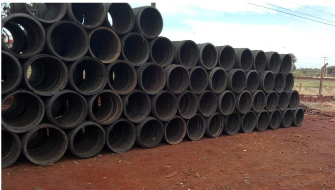
Figura 5– Tubos para drenagens produzidos com pneus inservíveis pela empresa A Fonte: Autoria própria (2014).
