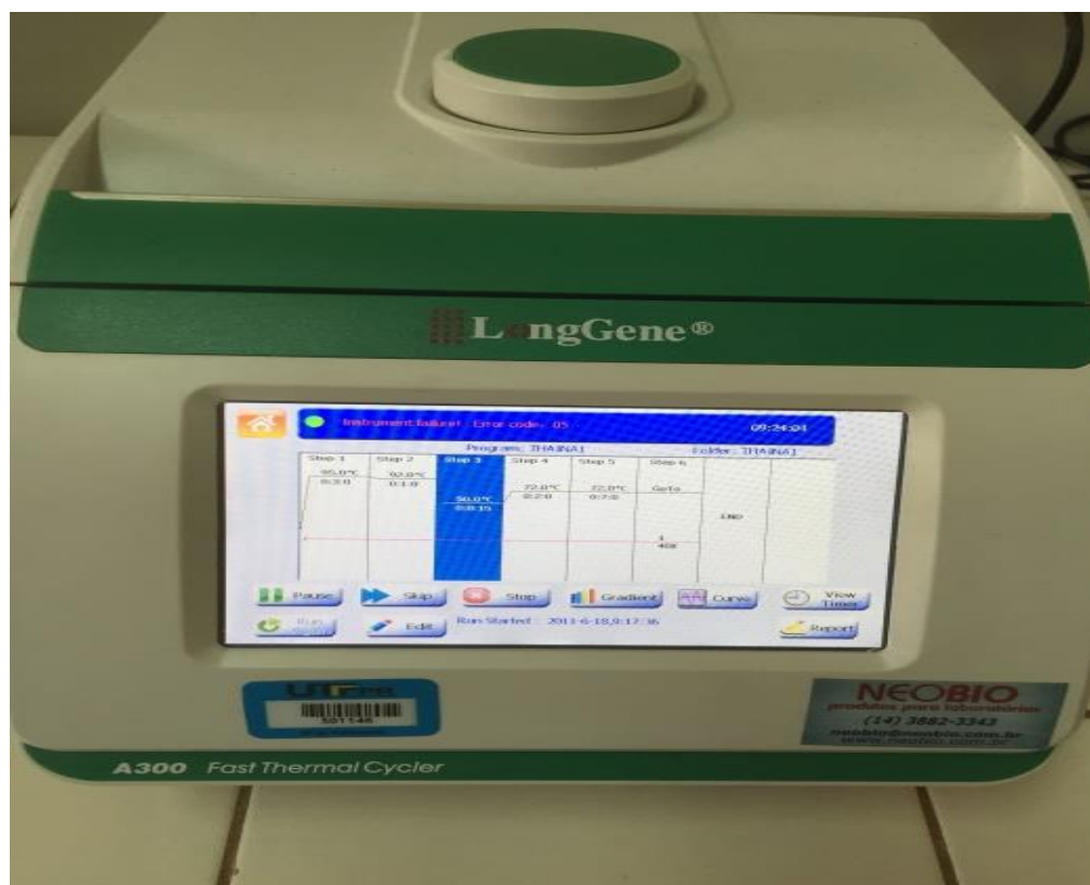
Figura 3: Equipamento Termociclador responsável pela incubação das amostras durante a fase de PCR.
