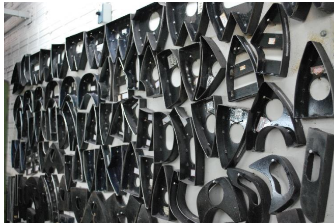
Figura 7 - Facas utilizadas na máquina de corte. Fonte: Autoria própria.
