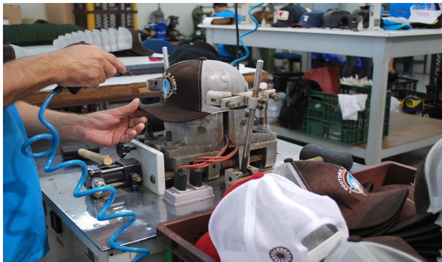
Figura 19 - Funcionário operando o produto na passadeira. Fonte: Autoria própria.
