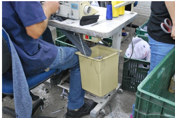
Figura 15 - Recipiente onde são armazenados os resíduos gerados nas máquinas de costura. Fonte: Autoria própria.
