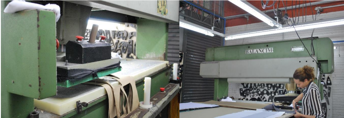
Figura 6 - Máquina de cortar tecido com facas. Fonte: Autoria própria.
