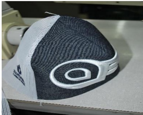
Figura 11 - Parte frontal costurada com as laterais direita e esquerda. Fonte: Autoria própria.
