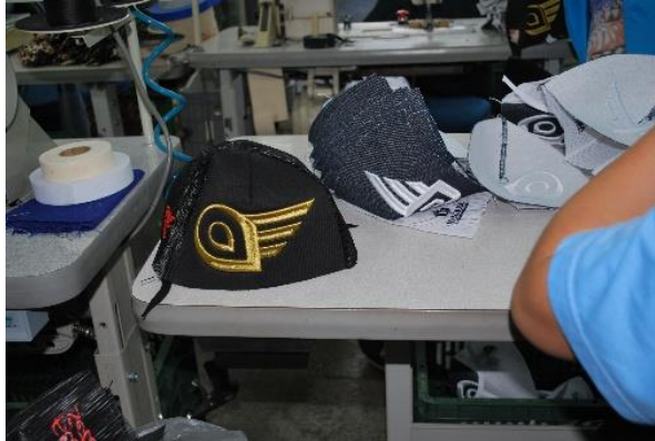
Figura 12 - Peça frontal, lateral direita, lateral esquerda e traseira costuradas. Fonte: Autoria própria.
