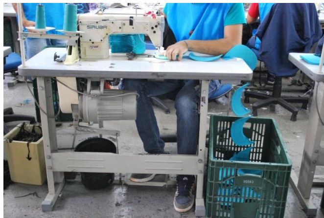
Figura 13 - Processo de costura da aba do boné. Fonte: Autoria própria.
