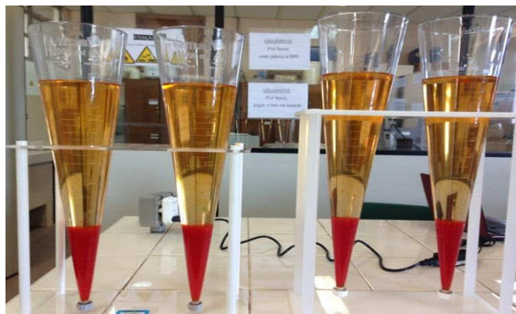
Figura 5 – Aspecto dos cones Imhoff, utilizados para mensurar o volume do lodo gerado.
