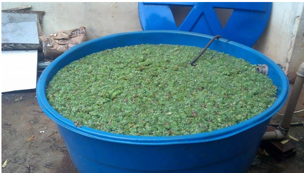
Figura 2 – Foto do tanque de Biotratamento com Salvinia herzogii e Salvinia auriculata . Na parte superior: saída de água tratada através da mangueira. À direita na superfície do tanque: Saída de excesso de água (evitando transbordo descontrolado em dias chuvosos).
