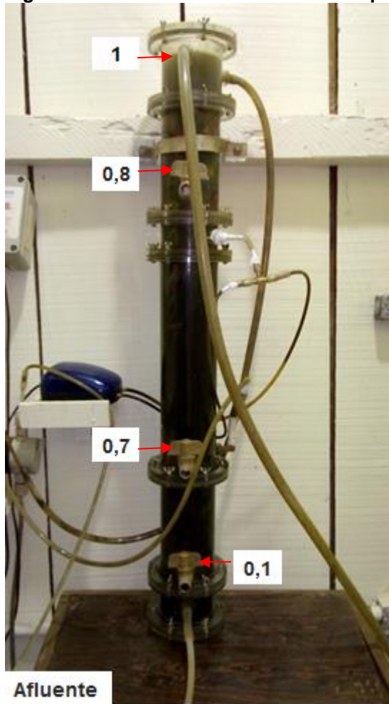
Figura 3- Pontos de coleta nos RCAALF para realização das análises físico-químicas
