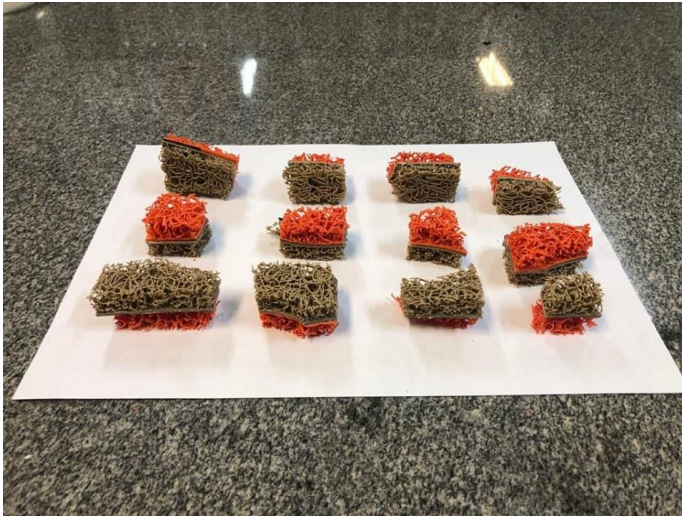
Figura 5 - Matrizes cúbicas de fibra vinílica entrelaçada utilizadas como meio suporte.
