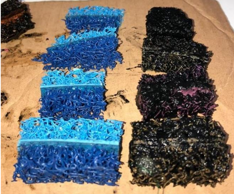
Figura 6 – Biofilme aderido ao meio suporte, após 112 o dia de operação do reator.
