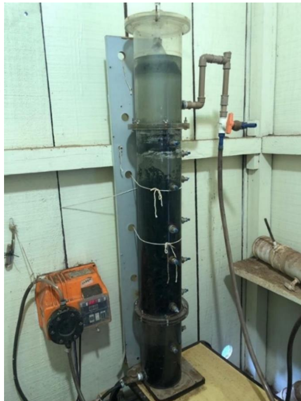
Figura 4 - Esquema do Reator UAHB (direita) em escala de bancada e foto do Reator UAHB (esquerda).
