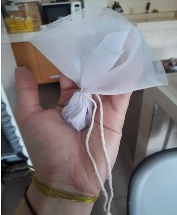
Figura 2. Tipo de saquinho confeccionado e utilizado para medir a perda de biomassa através do método Tea Bag Index .
