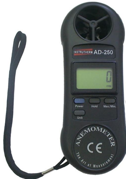
Figura 8 - Anemômetro Instrutherm modelo AD-250, utilizado para a medição da velocidade do ar.
