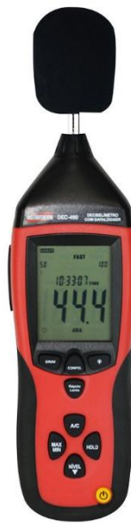
Figura 5 - Decibelímetro Instrutherm modelo DEC-490, instrumento empregue nas medições do Nível de Pressão Sonora.
