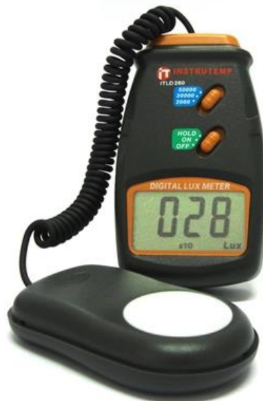
Figura 6 - Luxímetro Digital Instrutemp modelo ITLD-260, utilizado para a medição da iluminância nos ambientes.
