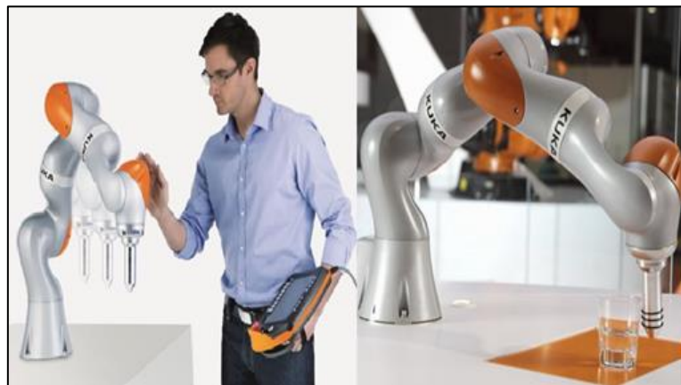
Figura 2 - Robô manipulador LBR IIWA 7 R800 Fonte: KUKA (2016).
